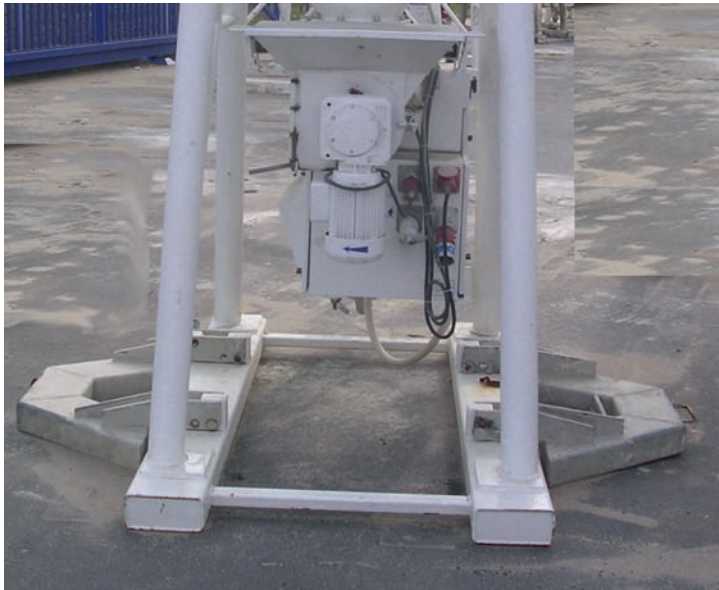
Bild 4: Verbreiterung der Aufstandsflächen zur Erhöhung der Standsicherheit
