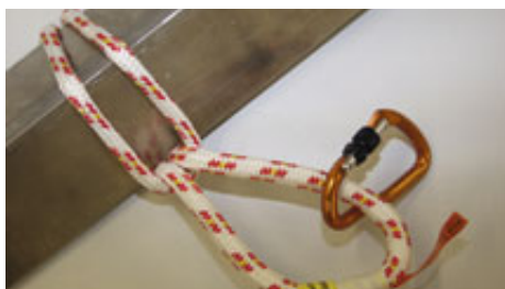
Abb. 35 Seilschlaufe zur Schaffung eines Anschlagpunktes.
