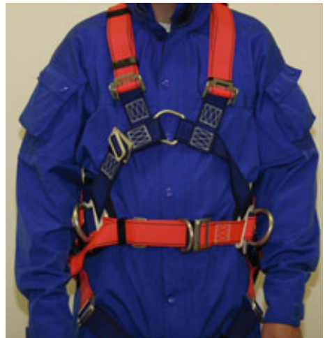
Abb. 20 Beispiel für einen Auffanggurt nach DIN EN 361 mit vorderer Auffangöse und einer Steigschutz- öse. Der Bauchgurt ist mit zwei seitlichen Halteösen ausgestattet.
