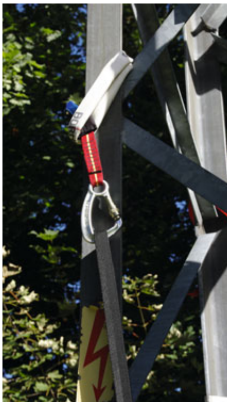
Abb. 37 Beispiel einer speziellen Bandschlaufe für erhöhte Belastungen. Im Belastungsfall können Band- und Seilschlaufen durch Scherkräfte in Konstruktionsteilen übermäßig belastet werden. Es empfiehlt sich ein Einsatz speziell für diese Verwendung ausgewiesener Schlaufen.
