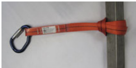
Abb. 34 Bandschlaufe zur Schaffung eines Anschlagpunktes.
