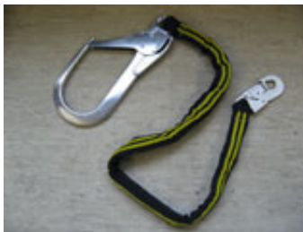
Abb. 29 Beispiel für einen Falldämpfer, in dem die Fall- energie in einem Fangstoß dämpfenden speziellen Traggeflecht absorbiert wird.
